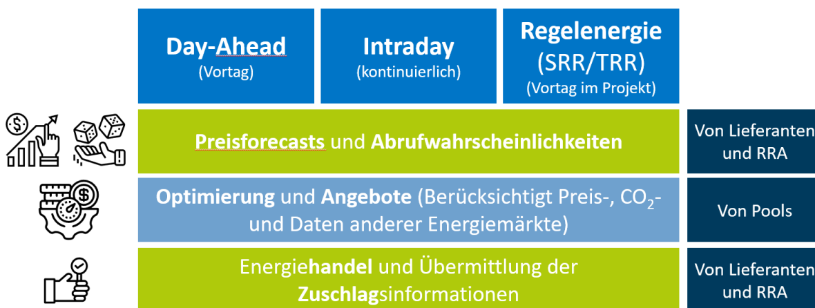
Abbildung 46 Schematische Übersicht zum Ablauf der Handels- und Optimierungsprozesse
