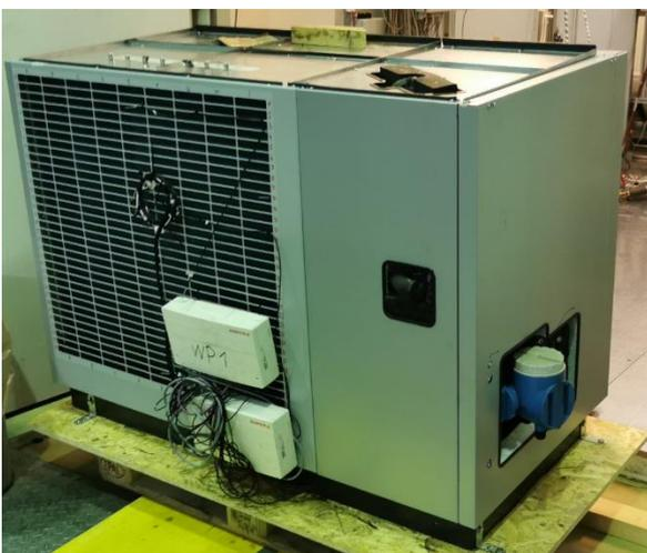
Abbildung 32: Wärmepumpen-Funktionsmuster in der Klimakammer des IWT
