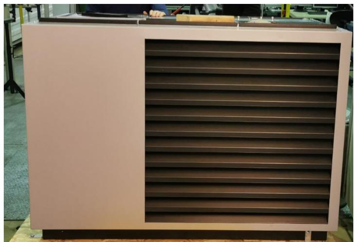
Abbildung 33: Rückansicht des Wärmepumpen-Funktionsmusters mit Schallschutz-Lamellen
