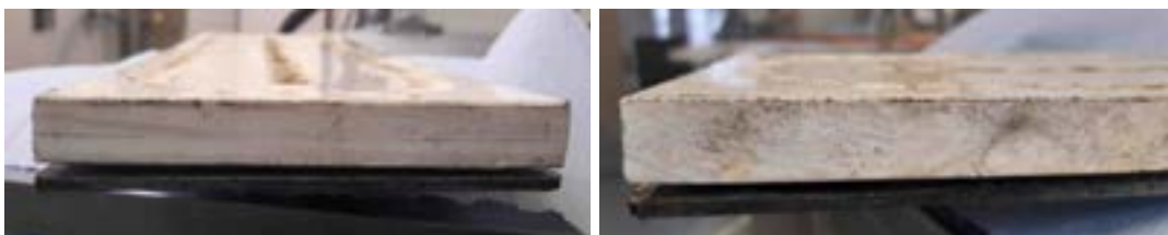
Abbildung 23: Seitenansicht des Magnetronsystems (Version 2) nach dem Beschichtungstest: Die Kunststoffplatte für die Positionierung der Magneten löste sich durch die Kühlwasserzirkulation von der Metallrückplatte
