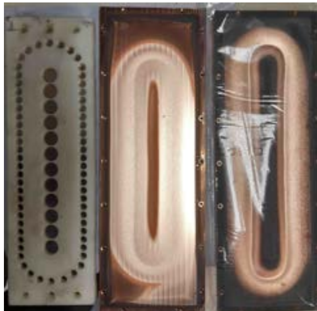
Abbildung 21: links: Neu konzipiertes Magnetron-System (Version 1); Mitte: Targetracetrack eines Kupfer-Targets nach dem Sputter-Testprozess; Rechts: Targetracetrack eines verbrauchten Kupfertargets mit dem ursprünglichen Magnetron (Anm.: Reflexion durch Plastikverpackung);
