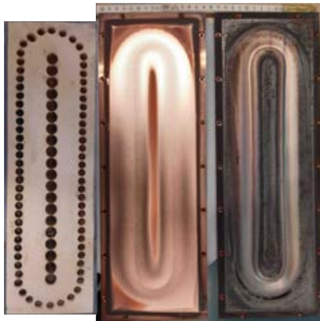
Abbildung 22: Neu konzipiertes Magnetron-System (Version 2) mit verlängertem Racetrack; Mitte: Targetracetrack eines Kupfer-Targets nach dem Sputter-Testprozess; Rechts: Targetracetrack eines verbrauchten Kupfer-Targets mit dem ursprünglichen Magnetron (Anm.: die Oberfläche dieses Targets ist teilweise selenisiert und daher grau);
