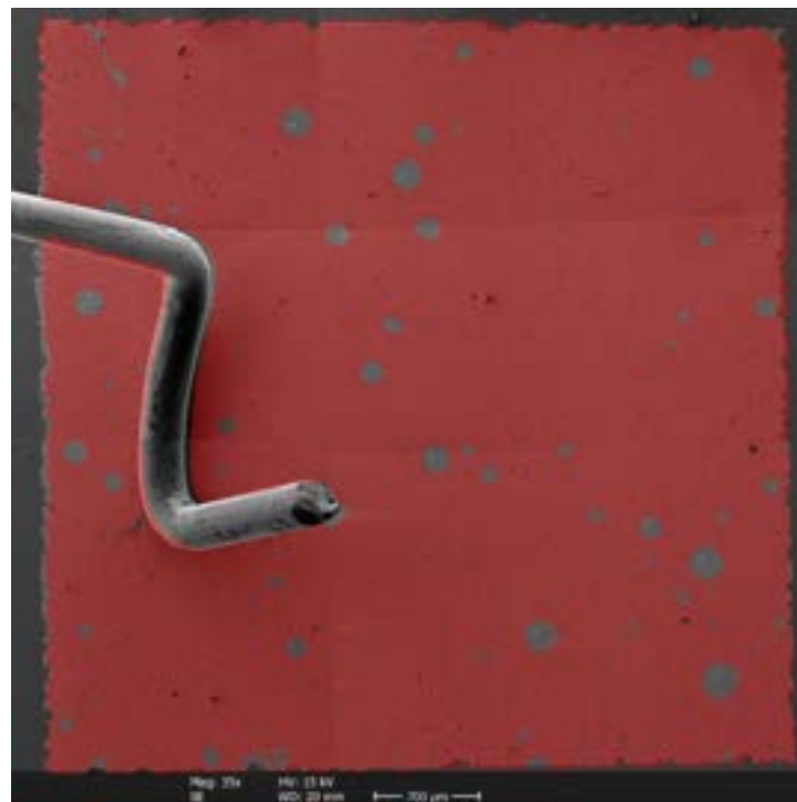
Abbildung 37: Überlagerung von EBIC Signal (rot) auf SE-Signal (Hintergrund). Die beiden Signale werden im Normalfall gleichzeitig aufgenommen und können somit übereinandergelegt werden. Das Highlight in diesem Fall ist es, dass es sich nicht um eine einzelne Aufnahme handelt (Vergrößerung kann nicht weiter Reduziert werden), sondern um ein Zusammenfügen 6 einzelner Aufnahmen.
