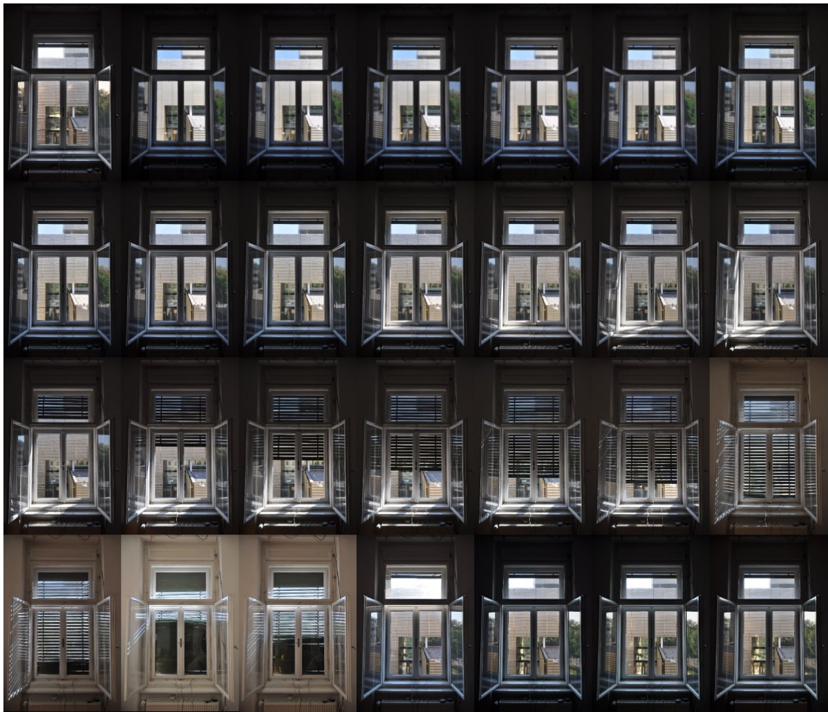
Abbildung 18: Aufnahme Rollladenposition alle 15 Minuten, sonniger Vormittag (Start unten rechts, zeilenweise nach links)
