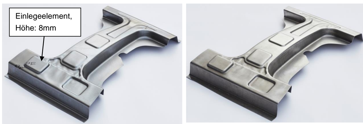
Abbildung 5: Rissfreie, tiefgezogene Miniatur-B-Säulen, umgeformt bei -150\text{ °C} ; links: EN AW 5083, rechts: EN AW 5182.
