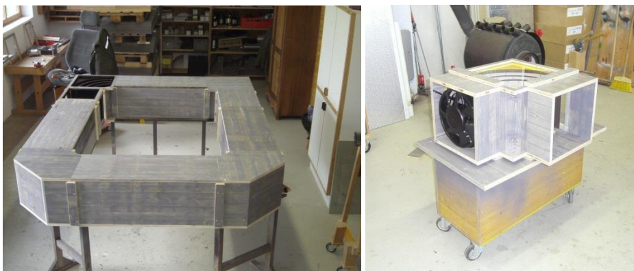
Abbildung 8 (links): Strömungskanal mit Umlenkung und Messfenster (links hinten); (rechts): Umlenkelement (B111B) mit Ventilator
