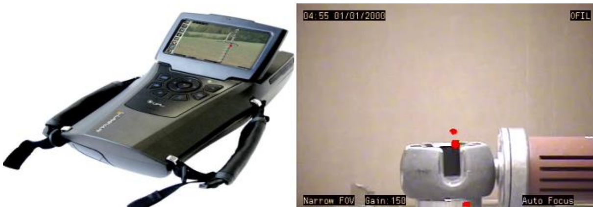
Abbildung 15: Luminar-DayCor-HD-Kamerasystem links, Aufnahme einer Detektion der Ofil Luminar DayCor HD bei einem Abstand von 5 Metern und einer eingestellten Spannung von 50 kV rechts
