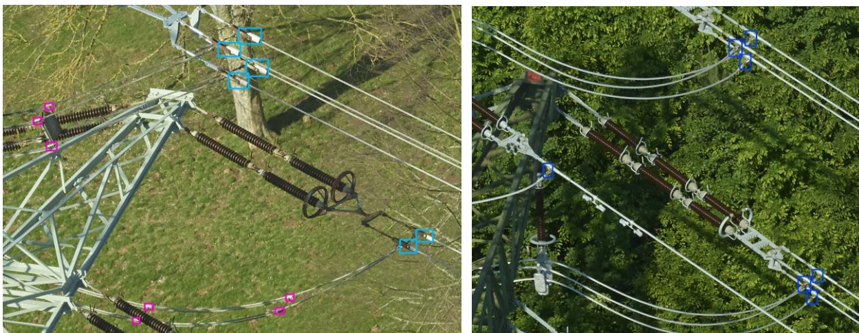
Abbildung 11: Bildbasierte Klemmendetektion – qualitative Ergebnisse
