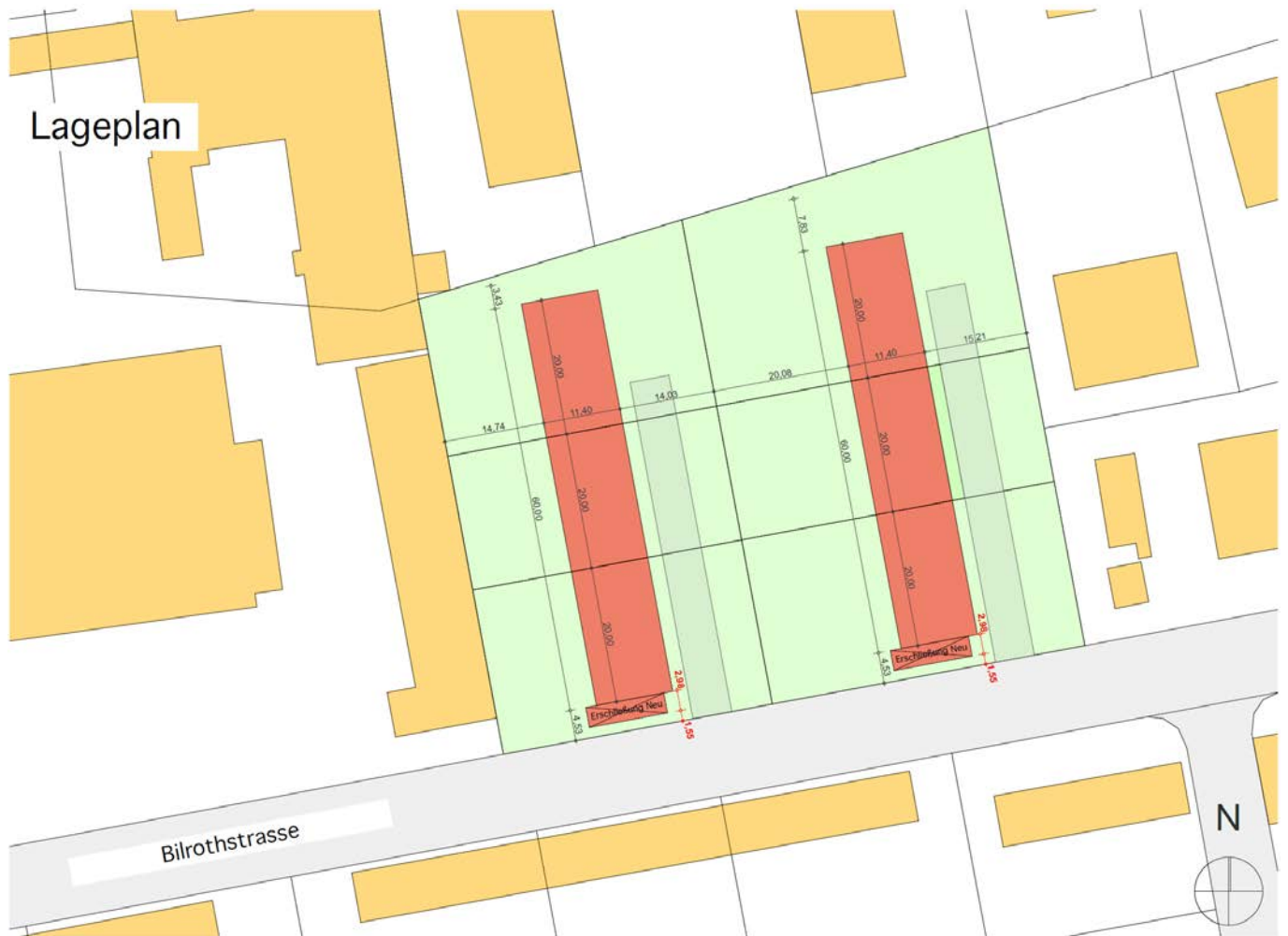
Abbildung 26 Lageplan mit den 2 Objekten die mit der ROOFBOX aufgestockt werden.
