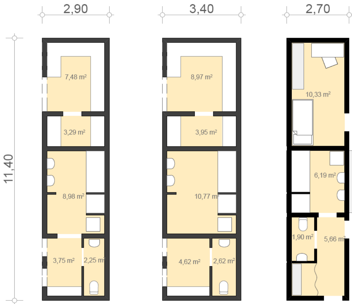
Abbildung 15 ROOFBOX-Abmessungen mit unterschiedlicher Breite. Quelle: Nussmüller Architekten
