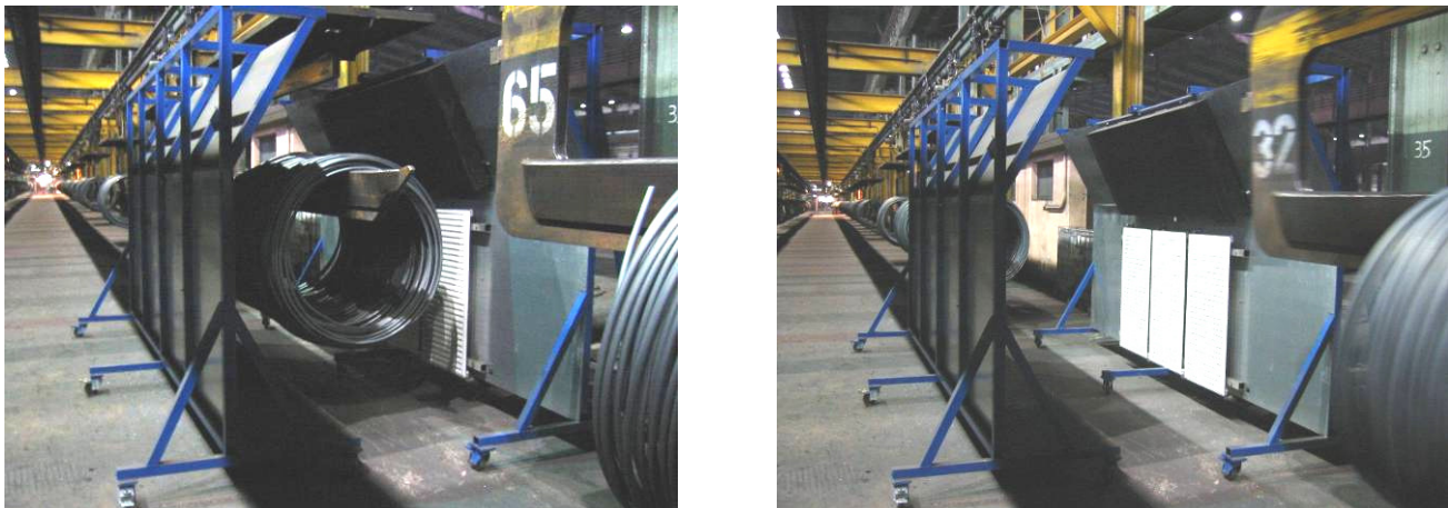
Abbildung 3: Versuchsanlage im Produktionsfluss mit Reflexionswand
