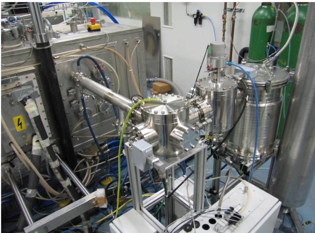
Abbildung 3: Integration eines externen Feststoffverdampfers (Dr. Eberl MBE-Komponenten GmbH) in die Cl(G)S-Beschichtungsanlage.
