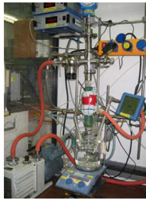
Abbildung 6: Messapparatur zur Bestimmung des Wasserpartialdampfdruckes
