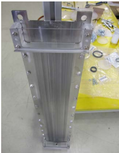
Abbildung 2: Wärmeübertragerplatte und Flüssigkeitsverteiler (links) und Seitenansicht mit angeschraubter Sekundärseite (rechts)
