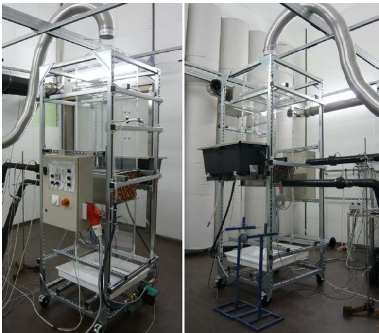
Abbildung 4: Versuchsaufbau Rückkühler (Vorder- und Rückseite) in einer Klimakammer am AIT
