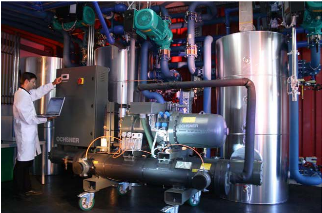
Abbildung 4: Ochsner IWP Prüfstand für Industriewärmepumpen (Quelle: Ochsner Wärmepumpen GmbH / Ochsner Energie Technik GmbH.)
