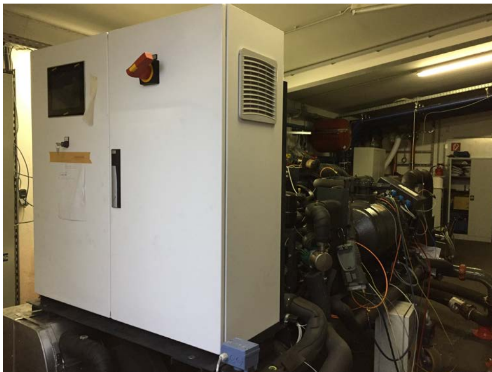
Abbildung 6: Zweistufiges HTWP Funktionsmuster am OCHSNER IWP Prüfstand, Ansicht auf schalt- und Regelschrank mit Touch Display (Quelle: Ochsner Wärmepumpen GmbH / Ochsner Energie Technik GmbH.)
