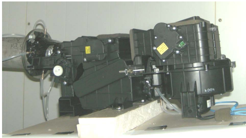
Abbildung 13: HVAC-Box verbunden mit dem Mess-Rohr
