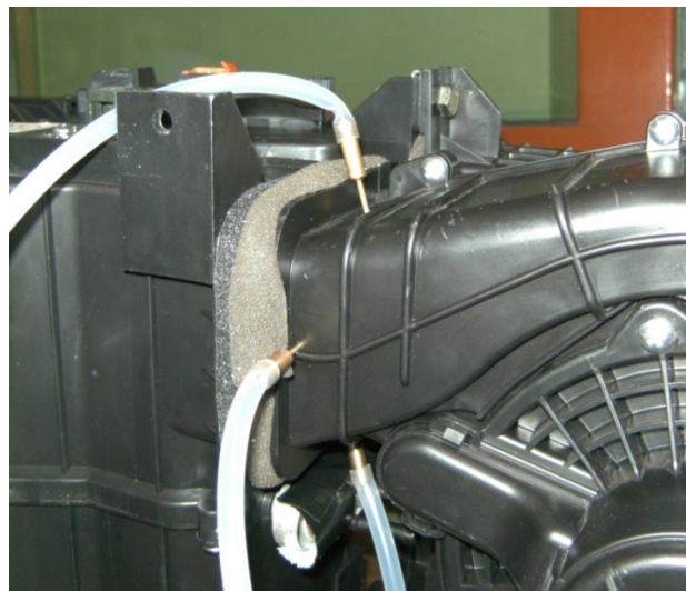
Abbildung 15: Anbringung der Druckmessstellen an der HVAC-Box
