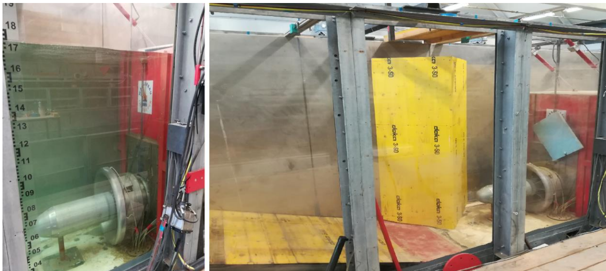
Abbildung 5: Prototyp einer StreamDiver-Kompaktturbine im Maßstab 1:4 im Turbinenversuchsstand bei Versuchsdurchführung (links) und nach Einbau des Keiles über die halbe Querschnittsbreite unmittelbar vor der Turbine (Variante 1) (rechts)
