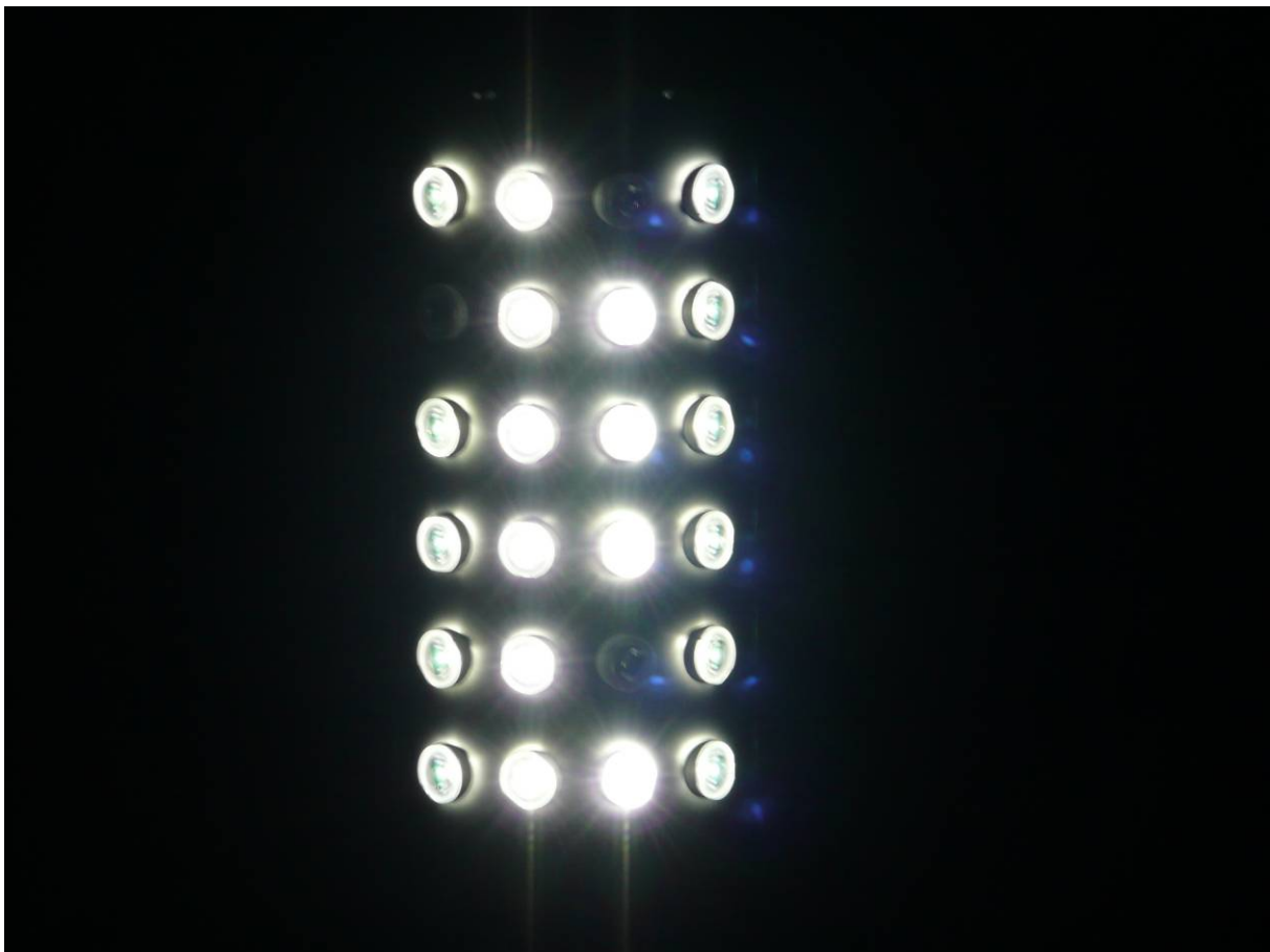
Abbildung 8: LED-Ausfall am Standort Wieselburg/Schulberg
