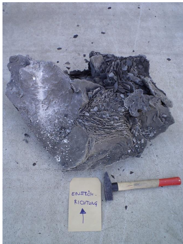
Abbildung 6: Massive Ausfällungen vor dem Wärmetauscher bei einer Anlage
