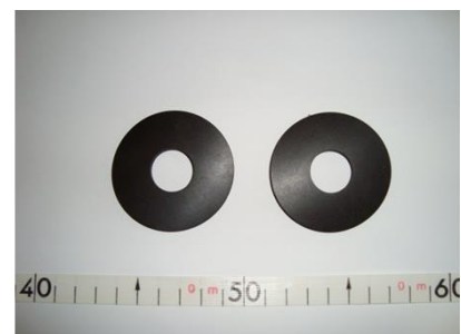
Kunststoffe: Polyamidscheiben und Hartgummiringe
