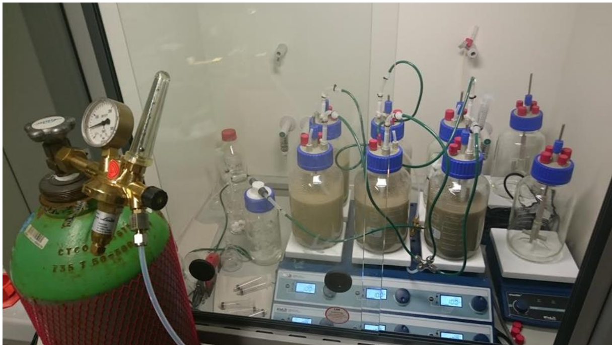
Abbildung 17: Foto des Versuchsaufbaus zu Wasser-Gesteins-Interaktionen
