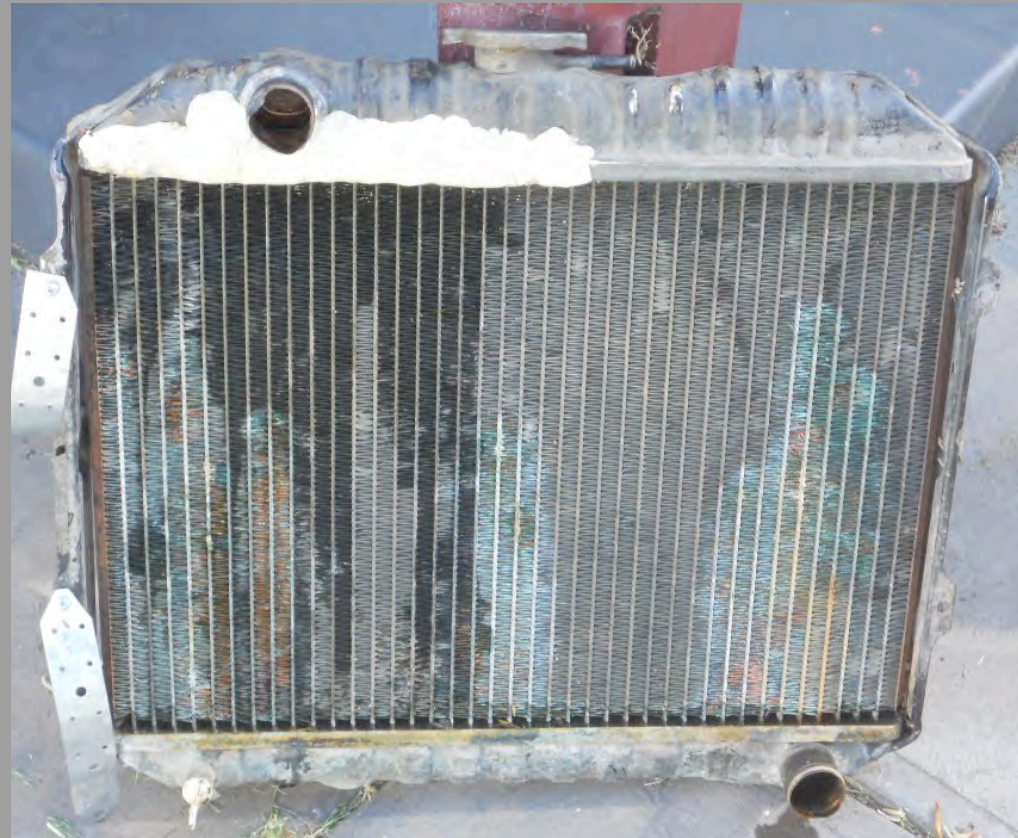
Verkalkter Wärmetauscher (extremes Beispiel)
