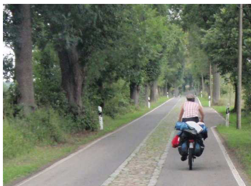
Abbildung 37: Beispiele für verkehrsberuhigte Straßen: links: durch den gepflasterten Mittelstreifen werden Kfz gebremst, während RadfahrerInnen auf den asphaltierten Flächen ungehindert fahren können (Parlow, Friedrichswalde, Deutschland, Foto: JAVUREK); rechts: „Shared Space“ Konzept: Raum für FußgängerInnen wird auf Kosten der Fahrbahnbreite durchgehend aufrecht erhalten, kann aber auch überfahren werden (Heufurth, Österreich, Foto: MITSCH)
