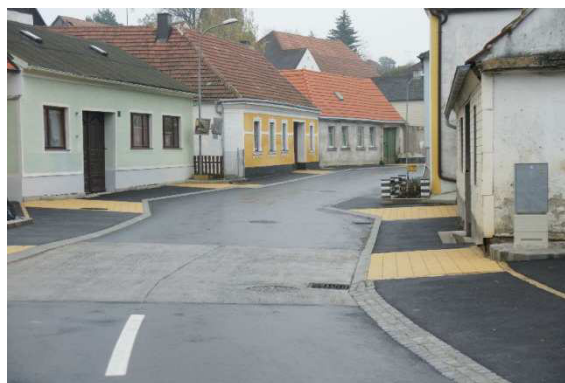
Abbildung 37: Beispiele für verkehrsberuhigte Straßen: links: durch den gepflasterten Mittelstreifen werden Kfz gebremst, während RadfahrerInnen auf den asphaltierten Flächen ungehindert fahren können (Parlow, Friedrichswalde, Deutschland, Foto: JAVUREK); rechts: „Shared Space“ Konzept: Raum für FußgängerInnen wird auf Kosten der Fahrbahnbreite durchgehend aufrecht erhalten, kann aber auch überfahren werden (Heufurth, Österreich, Foto: MITSCH)
