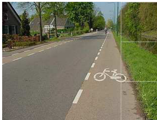
Abbildung 38: Beispiele für verkehrsberuhigte Straßen: links: Nebenstraße für Durchfahrt von Autos gesperrt (Feldkirch, Österreich, Foto: JAVUREK), rechts: „Kernfahrbahn“: Fahrbahn ohne Mittelstreifen mit beidseitigen Mehrzweckstreifen für Fahrräder; Autos fahren dadurch vorsichtiger und mehr in der Mitte (Niederlande, Foto: Ruud Ditewig, KERNFAHRBAHN)
