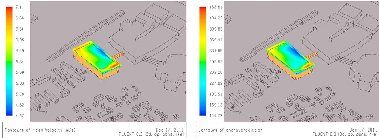
Basisvariante vereinfachtes Geometriemodell: Isofläche in 6 m Abstand zur Gebäudeoberfläche gefärbt - links - mit dem Betrag der Windgeschwindigkeit in [m/s] und - rechts – mit dem Betrag der zugehörigen Energiestromdichte [ W/m<sup>2</sup> ], in beiden Fällen Jahresmittelwert über die simulierten sieben Windrichtungen. (Man beachte die Farbskala.)
