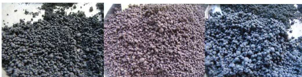
Abbildung 9: Laborgranulate mit verschiedenen Bindersystemen
