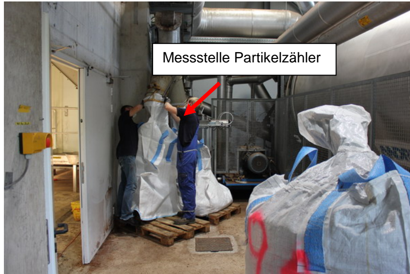
Abbildung 7: Big Bag Abfüllstelle, daneben Staub-Emissionsmessung
