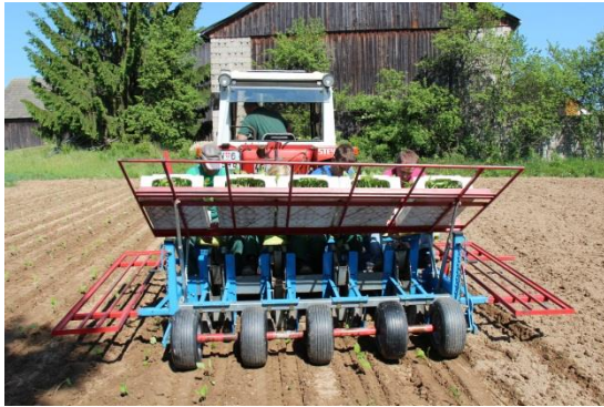
Abbildung 3: Bestandesbegründung durch Pflanzung mit einer Becherpflanzmaschine
