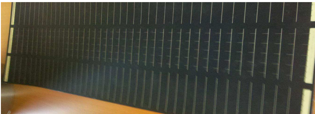
Abb. 26: 300 mm breites Anschauungsmodul (vorgestellt auf der Intersolar 2011) der SimpliCIS Technologie. Das Anschauungsmodul enthält alle funktionalen Schichten (außer den CIGS Absorber) und die gedruckte Kontaktierung.
