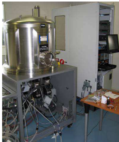
Abb. 4: Anlage zur Herstellung der Frontschichten
