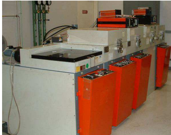
Abb. 3: Modifizierte Anlage zur Herstellung der Rückkontakt- und Precursor-Schicht für die Absorberherstellung
