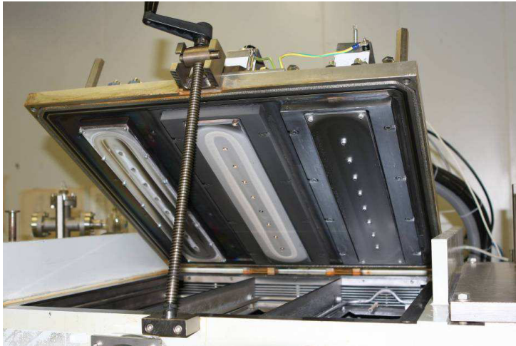
Abb. 5: Targets der PVD Anlage zum Sputtern von Rückkontakt und CIG Precursor (rechts: Mo, Mitte: CIG)
