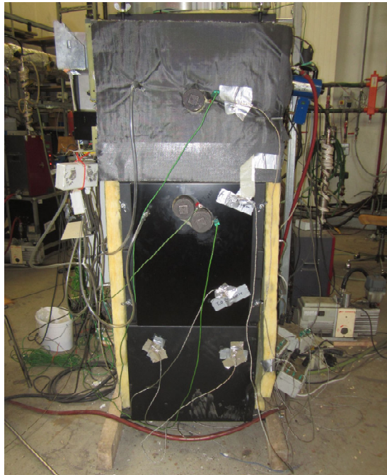
Abbildung 4: Foto der zweiten Versuchsanlage (Prototyp des neu entwickelten Pelletkessels) am Teststand bei BIOS
