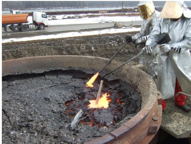
**Abbildung 6:** Temperaturmessungen in einem Schlackenkübel
