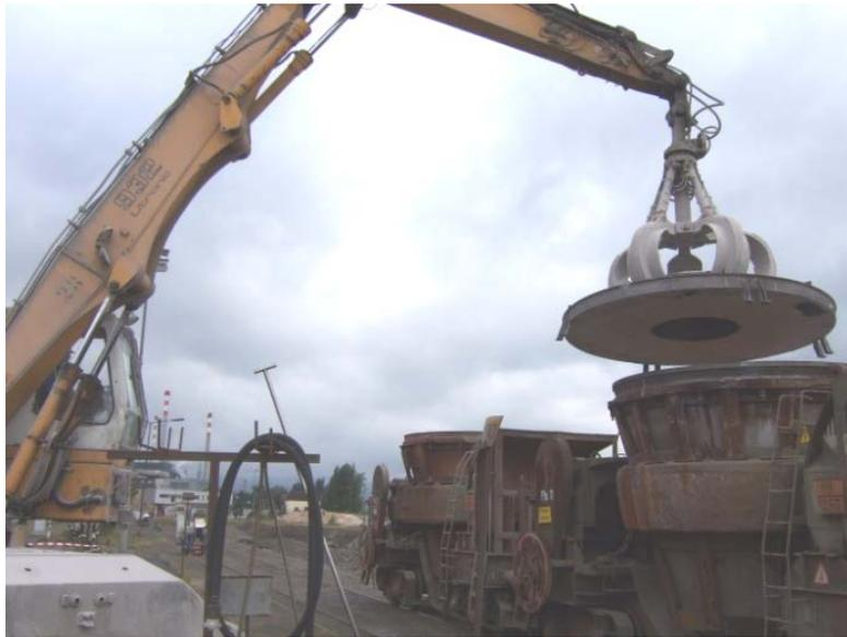
**Abbildung 8:** Abheben des Deckels von dem Schlackenkübel
