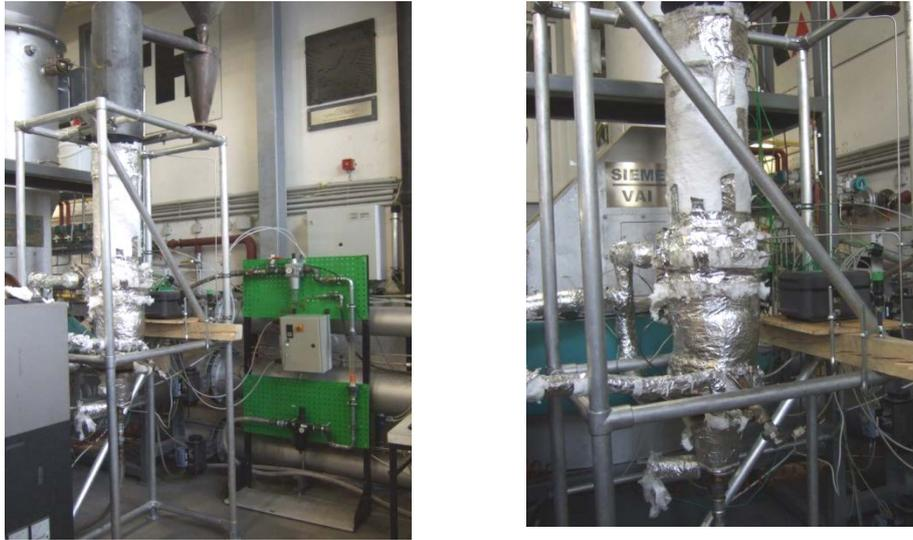
**Abbildung 3:** Wirbelschicht-Versuchsanlage
