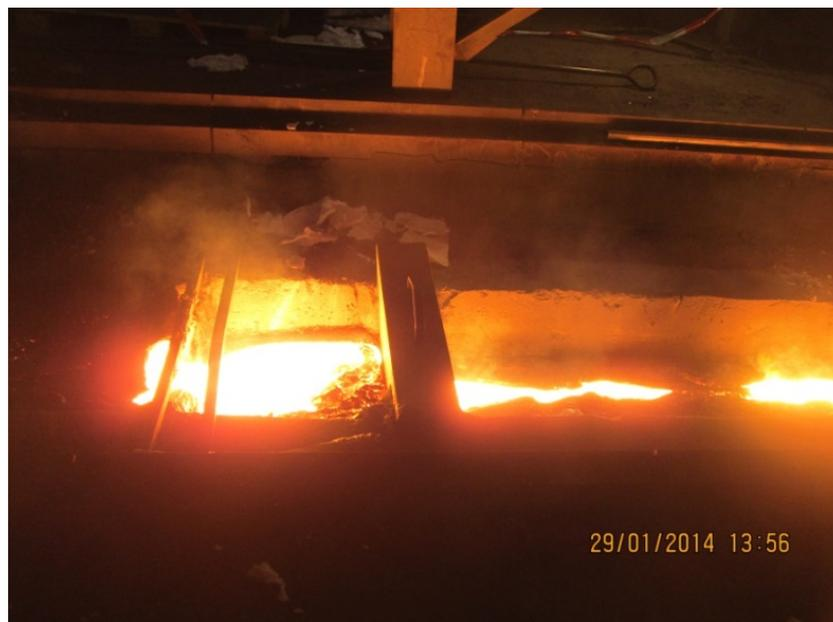
**Abbildung 16:** Schlackenstromregulierung mit Schlackenstaustein am Hochofen #A
