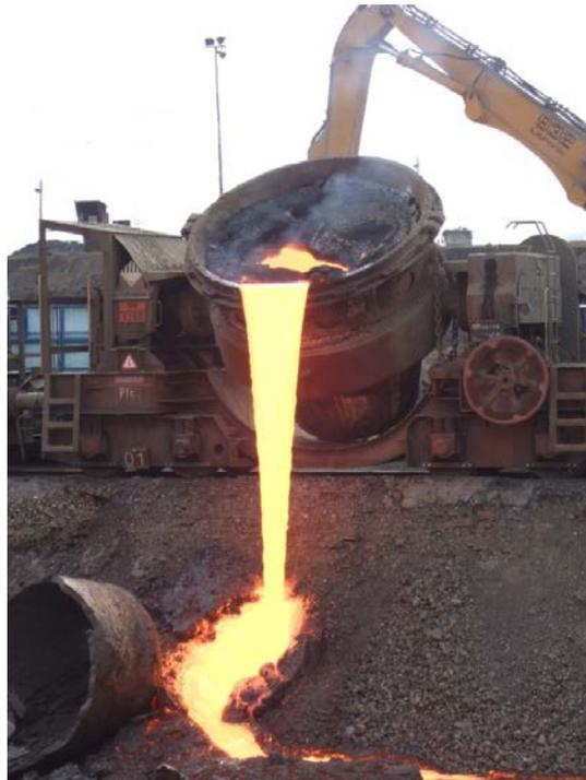
**Abbildung 7:** Abkippen der Schlacke aus dem Schlackenkübel
