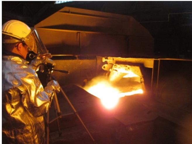
**Abbildung 10:** Schlacketemperatur-Messung in der Schlackenrinne am Hochofen #A
