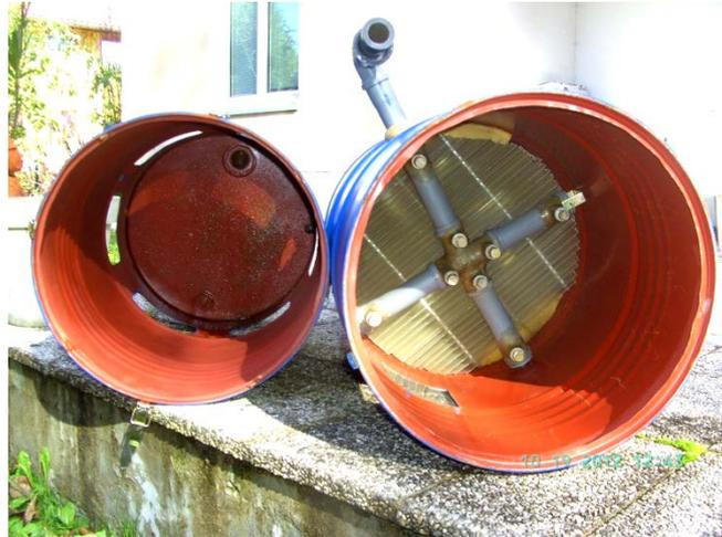
Abbildung 36: Innenansicht des Testkühlturmes
