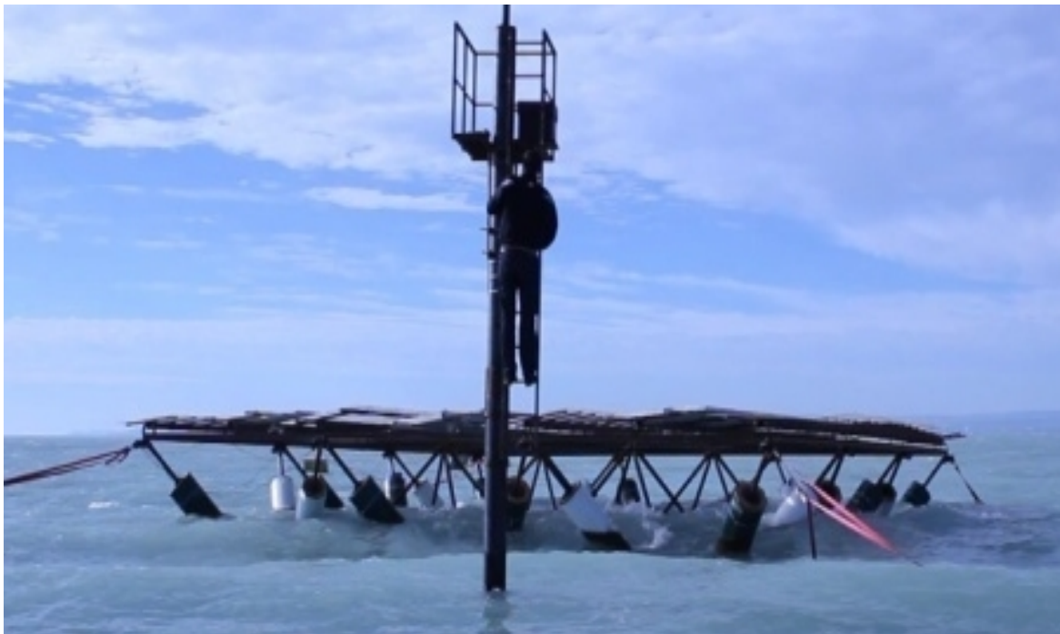
Abb.4: Erster semi-submersible Prototyp im Praxistest am Plattensee. Durchlaufende Welle, Prototyp 1.0. schwimmt ruhig.
