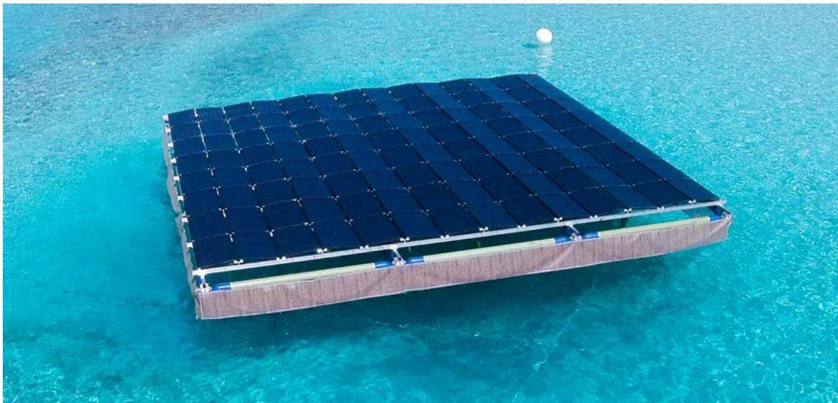
Abb.6: Prototyp 3.0 ist mit 28 kWp PV Leistung bestückt, schwimmt und liefert Strom
