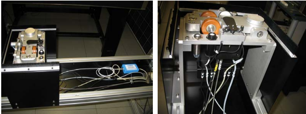
Abbildung 6: Aufbau Raman Messkopf mit Abstandshalterung
