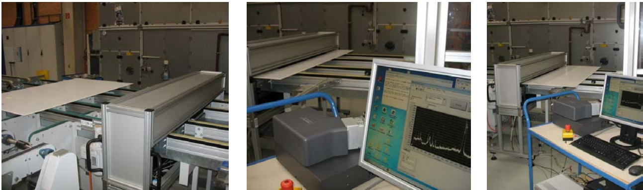
Abbildung 10: Modul bei der Vermessung - Laminat kommt, wird vermessen und fährt weiter ohne angehalten zu werden.
