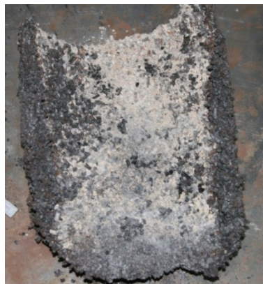
Abbildung 6-15: Ascherückstand aus dem ersten Verbrennungsversuch mit 100% Schilffanteil
