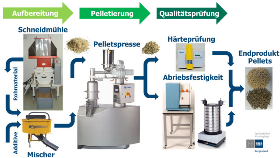
Abbildung 5-8: Schema Labor- Pelletieranlage
