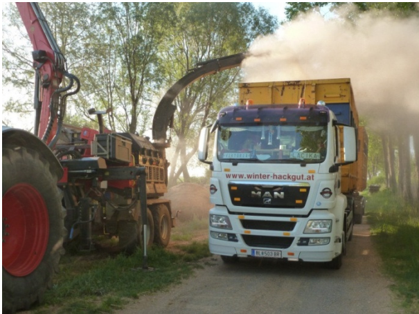
Abbildung 5-6: Mobiler Häcksler, angetrieben über die Zapfenwelle eines Traktors, befüllt den Container
