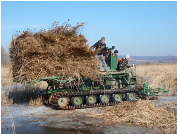
Abbildung 5-1: Bündelerntemaschine „Paul I“
