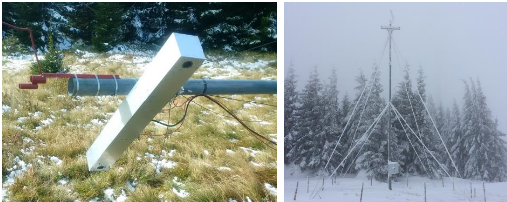
Abbildung 3: Kamerabasiertes 3D-Messsystem: Montage des Messsystems auf umgelegtem Messturm (links), Messturm mit Messsystem bei winterlichen Bedingungen (rechts)
