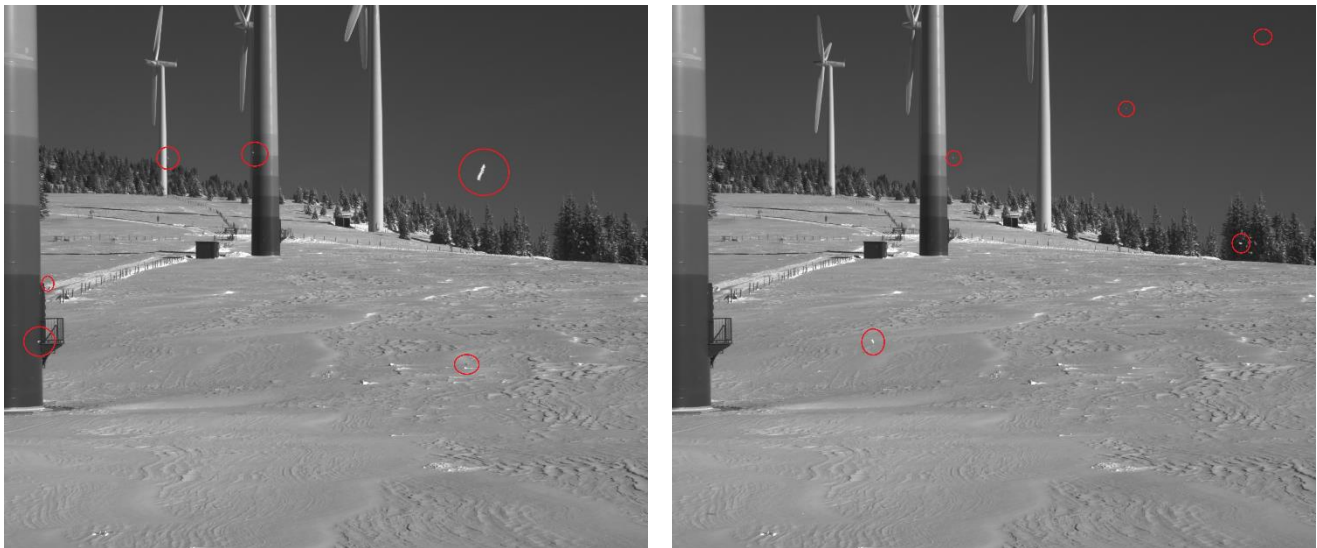
Abbildung 13: Beobachtung von Eisfall. Herabfallende Eisstücke sind im Kamerabild sichtbar (zur besseren Erkennbarkeit rot markiert).
